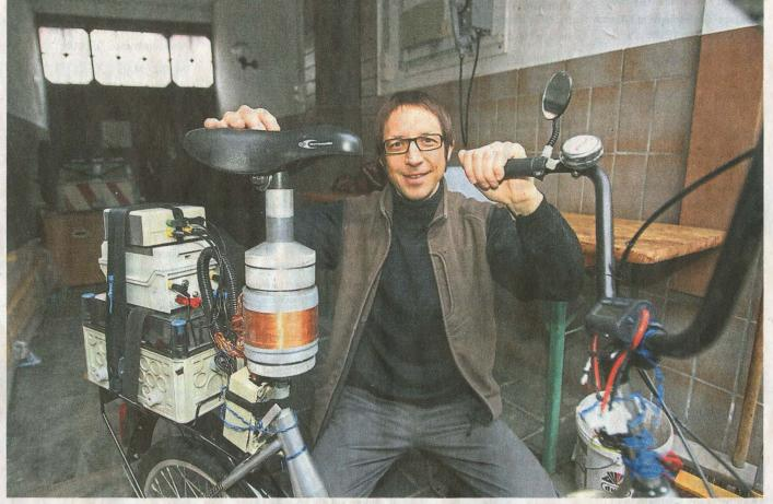
Er ist nur konservengroß: der zylindrische Metallbehälter unter dem Sattel fängt die Schwingungen, die beim Radeln entstehen, auf und wandelt sie in Strom um. Roland Stieb ist stolz auf seine Erfindung.
